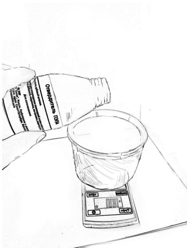
б) Для отвердителя Этал-45М рабочая пропорция составляет 2:1, на 100 грамм смолы следует добавить 50 грамм отвердителя. Общая масса смеси, таким образом, составит 150 грамм. **Важно!** При работе с небольшими объёмами смеси, до ~200 грамм, отвердитель можно
